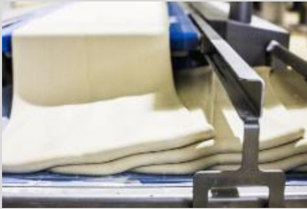
La pâte est automatiquement pliée en quatre, sur la chaîne de fabrication. Elle sera de nouveau repliée plus tard, ce qui permet d'avoir une vraie pâte feuilletée.
